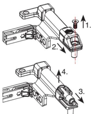
1. Sicherungsschraube entfernen.
