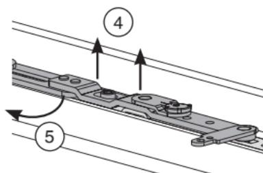
4. Scheren- bzw. Drehbandarm anheben bis er völlig frei ist ④, danach in den Rahmen schwenken ⑤.
